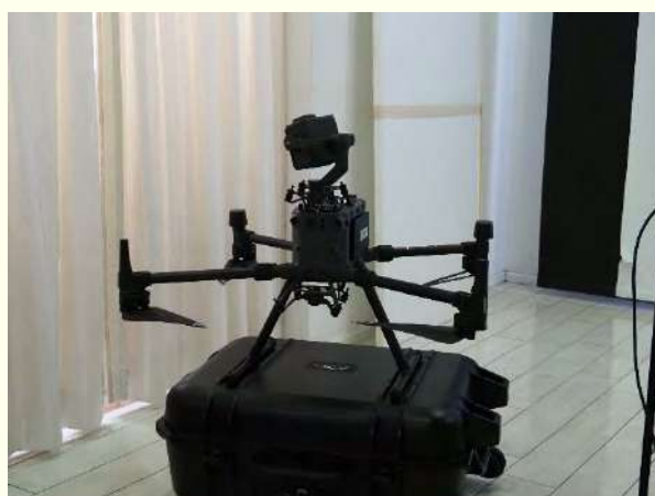
橋梁点検用ドローン
