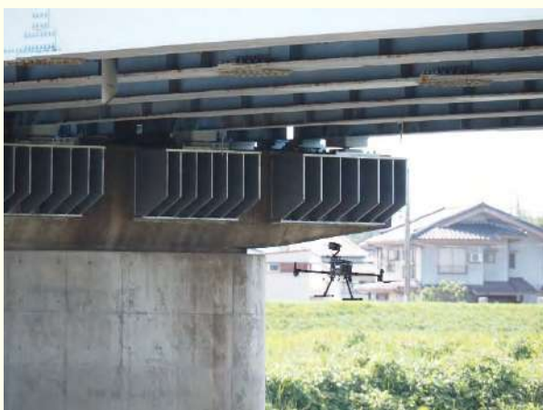
橋梁点検用ドローン
